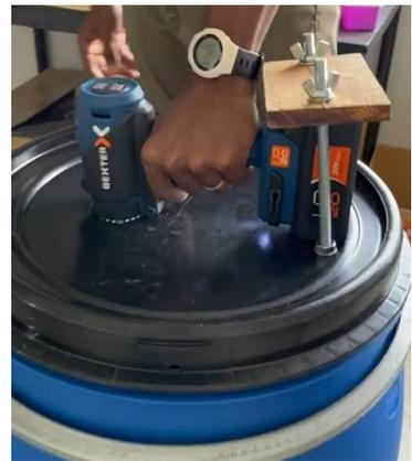
1. Perçage du couvercle à l'aide d'une scie cloche
