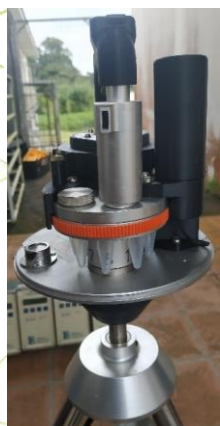
Intérieur d'un piège à spore (multi-vial cyclone sampler)
