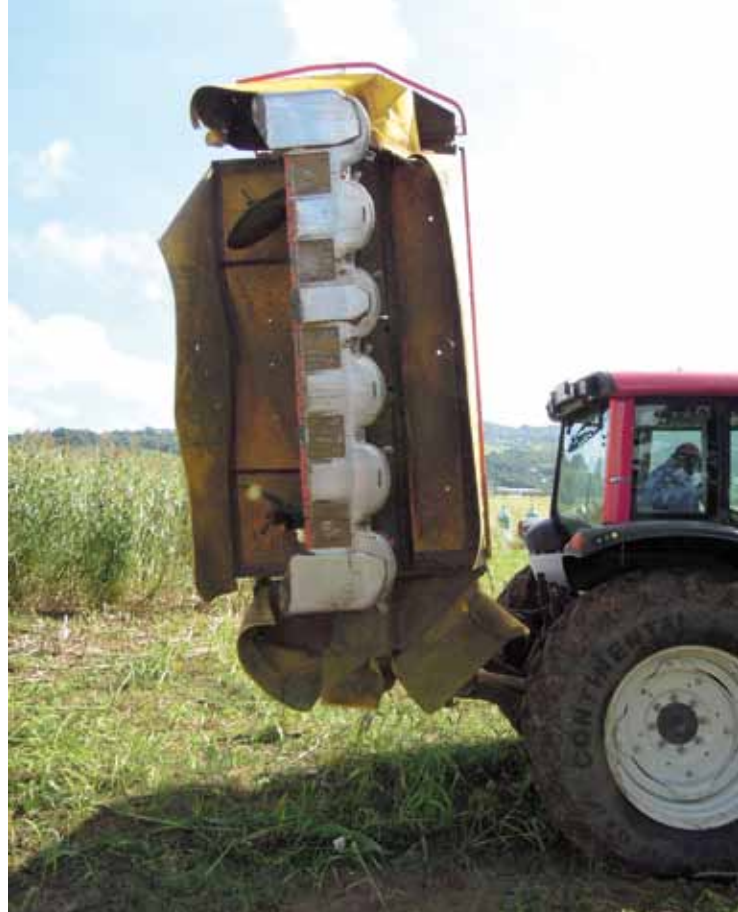
Faucheuse à disque déporté utilisée pour favoriser et/ou contrôler la biomasse des couverts - Photo IT2
