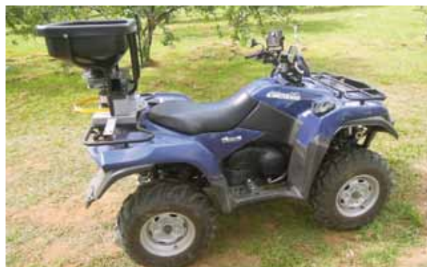
Quad équipé d'un épandeur d'engrais adapté au semis à la volée de semences de plantes de services - Photo IT2
