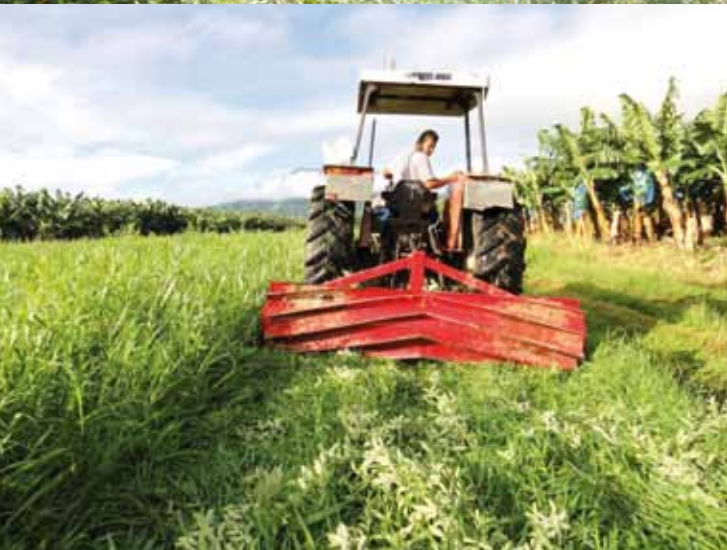
Exemples de rouleaux : cross-kill (en haut), et à cornières (en bas) pour détruire mécaniquement certains couverts - Photos IT2
