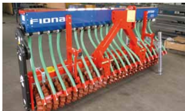
Exemple de semoir mécanique (équipé d'un rouleau tasseur) utilisé par les prestataires de semis - Photo IT2
